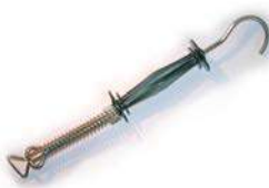
Rif. 11B Maniglia inox per nastro elettrico da 20 e 13 mm. Si fissa sui tenditori portacontatto.
