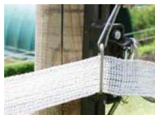
Step 1 Passare il nastro dentro la fibbia del tenditore Rif. 44V .
